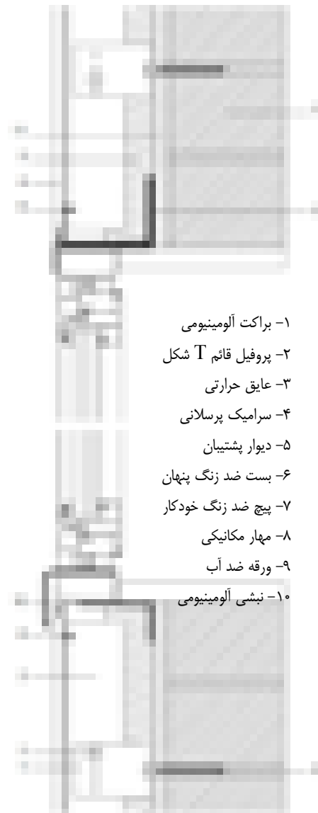
شکل ۷-۳۵- مقطع قائم در محل پنجره نصب پنهان
