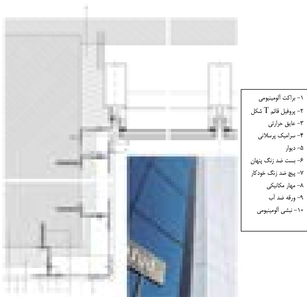
شکل ۷-۳۸- مقطع گوشه نصب پنهان
