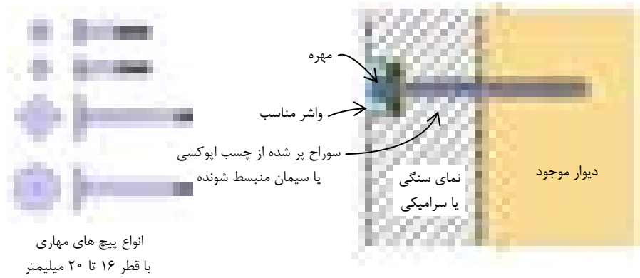
شکل ۵-۳۳- مقید کردن عناصر نما کاری
