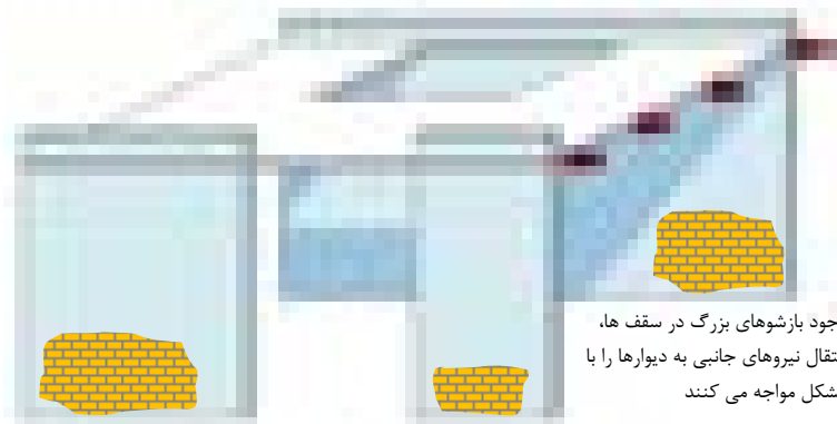
شکل ۵-۳- ناپیوستگی در مسیر نیروهای جانبی
